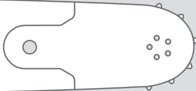
Vollstahlschiene mit austauschbarem Umlenkstern
